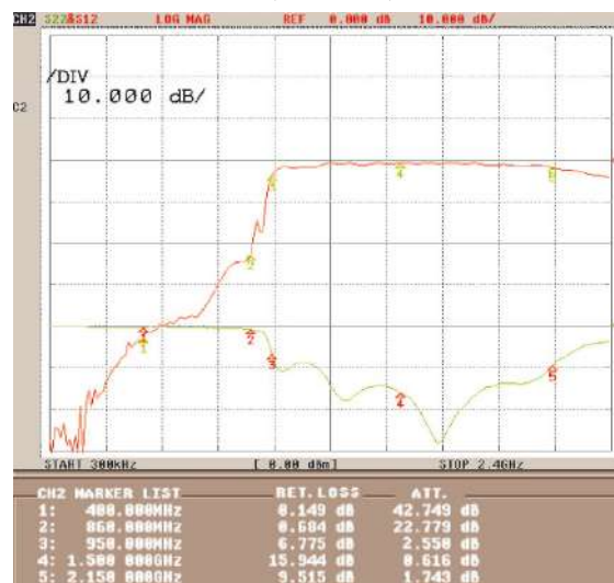
Tap SAT A/F response and return loss Tap SAT A/F потери на выходе и возвратные Respuesta y pérdidas retorno de la toma SAT A/F
