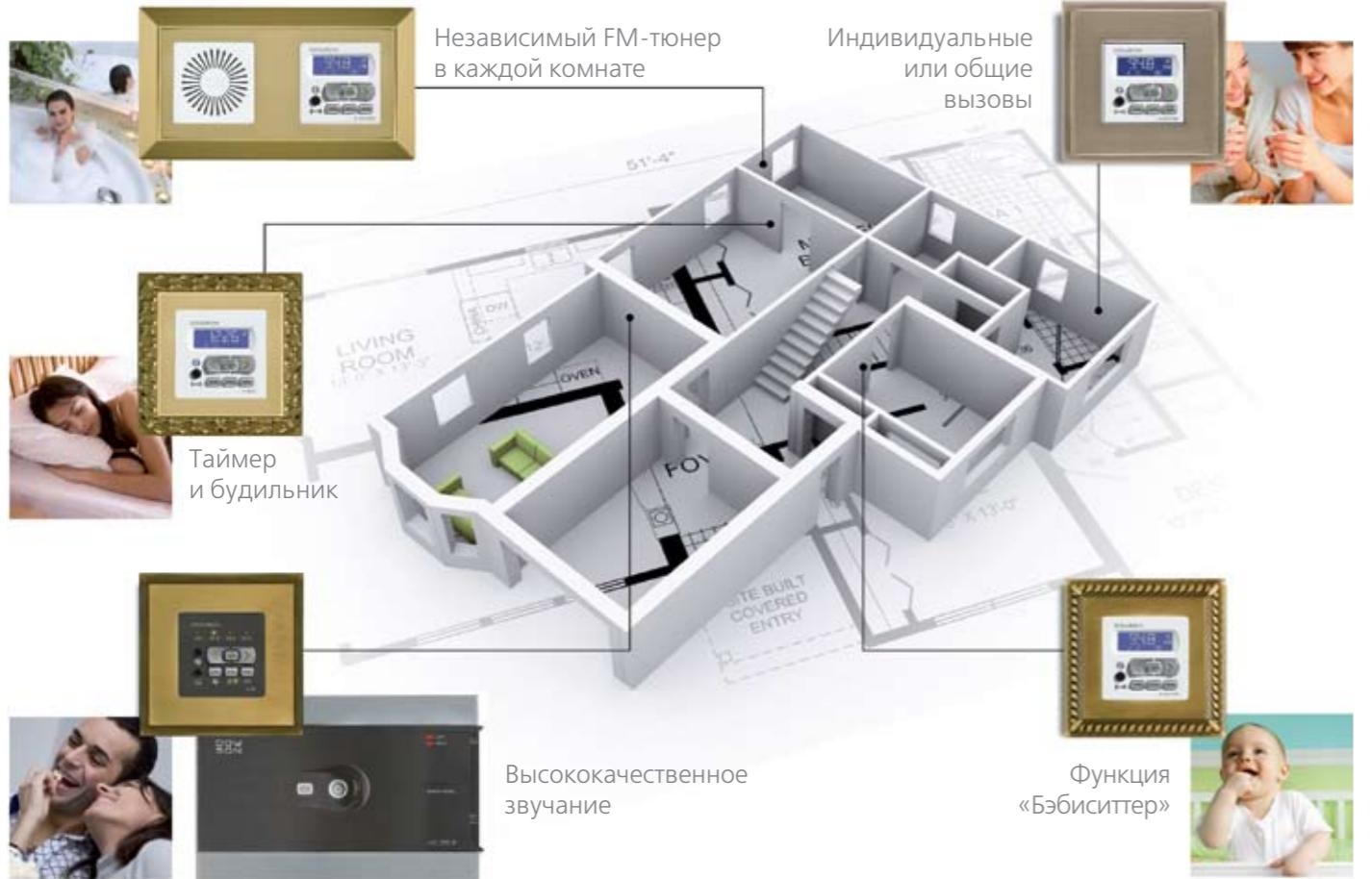
Основой системы управления звуком (мультирум) является центральный блок, который обычно устанавливается в гостиной. Он обеспечивает коммуникацию между различными элементами системы и подключение источников звука (CD-проигрыватель, домашний кинотеатр, MP3-плеер и т.д.).
