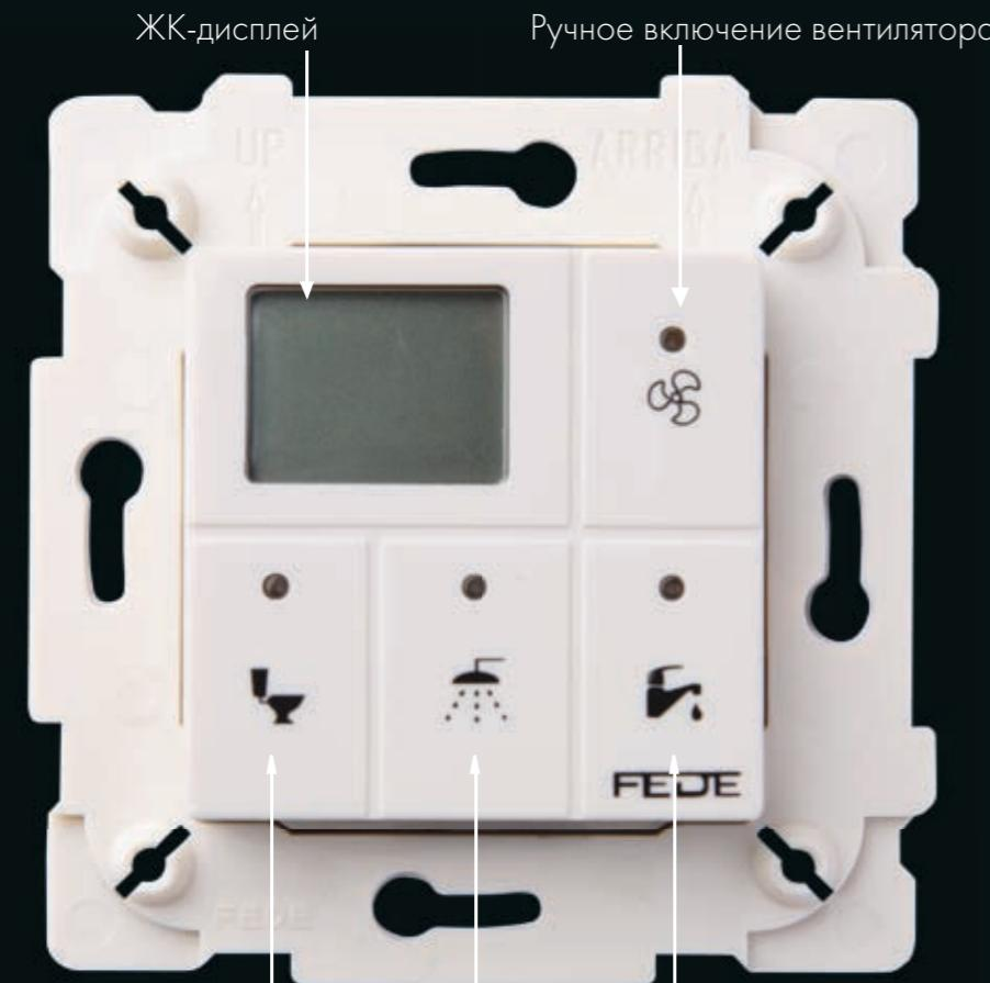
Данный сенсорный выключатель специально предназначен для одновременного включения света и вентиляции в ванной комнате при нажатии на любую клавишу. При выходе из ванной комнаты пользователь нажимает на клавишу с вариантом использования, после чего свет выключается, а вентилятор продолжает работать в течении заранее запрограммированного времени. В случае необходимости можно в ручном режиме включить только вентилятор.
